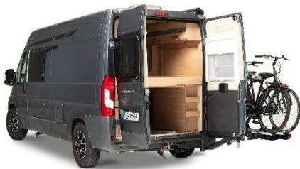
**Bildunterschrift 2:** Der Zugang zu den Hecktüren ist auch mit dem Heckträgersystem dank Schwenkfunktion stets gegeben.
