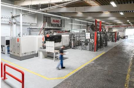
**Bildunterschrift 2:** Am Hauptsitz des Unternehmens in Kötz sind ab sofort zwei hochmoderne FIBER-Laserschneidanlagen vom Typ Bystronic ByStar Fiber 3015 in Betrieb.
