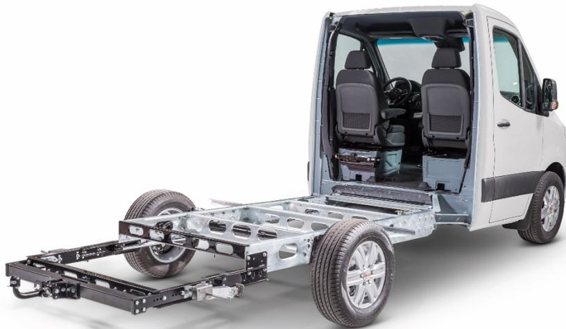
Bild 4: Der Green Caravanning Ansatz bei Reisemobilen führt maßgeblich über moderne abgesenkte Rahmenstrukturen wie das AMC-Chassis zu ausgeprägten Vorteilen bei Gewicht und Aerodynamik. © AL-KO Vehicle Technology Group
