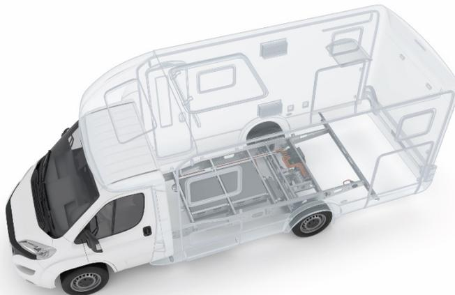
Bild 5: Das Hybrid Power Chassis ermöglicht emissionsfreies, vollelektrisches Fahren für Reisemobile und leichte Nutzfahrzeuge. © AL-KO Vehicle Technology Group
