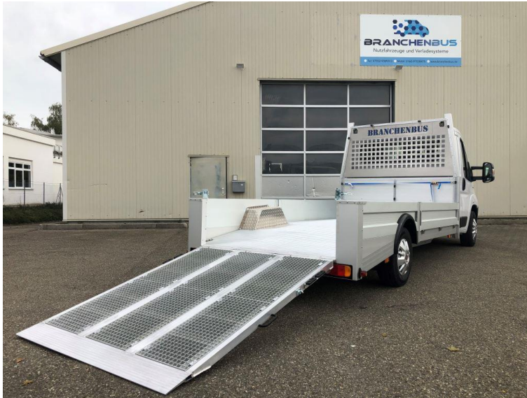
Bildunterschrift 4: Fiat Ducato mit einem Pritschenaufbau von Branchenbus und AL-KO Niederflur-Chassis. © Branchenbus GmbH
