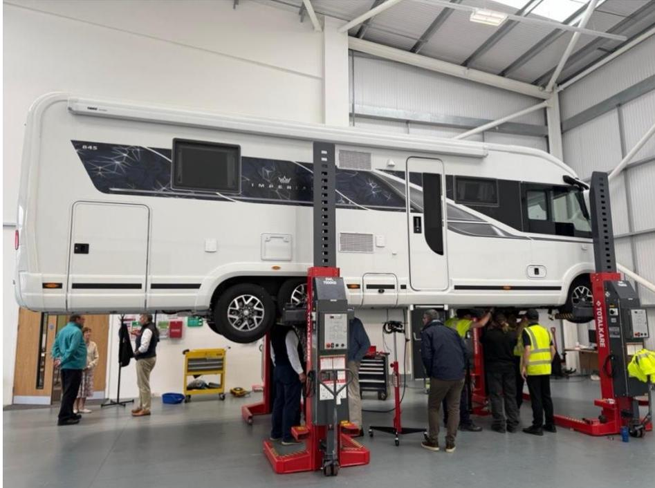
**Bildunterschrift 2:** Geschulte AL-KO Techniker bauen in der betriebseigenen Werkstatt beispielsweise hydraulische Nivelliersysteme ein
